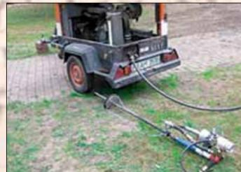
Pneumatisch betriebene Injektionslanze, Revita von MTM
