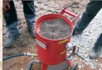
Vorratsbehälter für das Einbringen von sanoXit®-Injektionsprodukten mittels Terra-Tree 40 Sondermaschine von MTM
